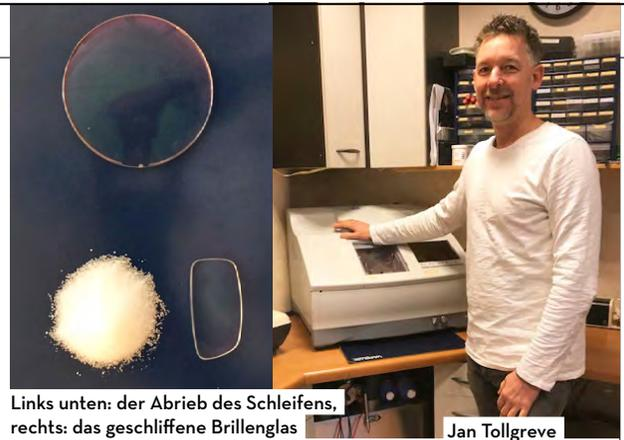
Links unten: der Abrieb des Schleifens, rechts: das geschliffene Brillenglas Jan Tollgreve
