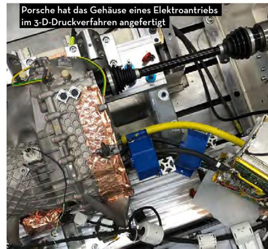
Porsche hat das Gehäuse eines Elektroantriebs im 3-D-Druckverfahren angefertigt
